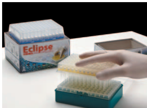
チップをラックにセット。スナップロードカバーを上から押し込み、ラックにプレートを固定させる。
